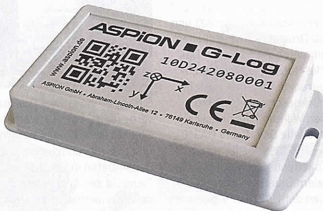
Nicht immer werden Güter während des Transports entsprechend den Vorgaben behandelt. Der G-Log liefert allen Beteiligten belastbare Daten für den Fall von Reklamationen. (Bild: Aspion)
